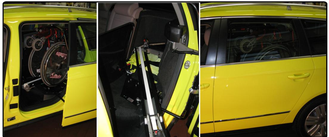
Erforderlich für den Einbau des "EDAG-Systems" sind Fahrzeuge mit 4 Türen, sowie geteilter Rücksitzbank. Fahrzeuge mit 4-Radantrieb sind nicht geeignet. Leider sind nicht alle Fahrzeugtypen umrüstbar. Beachten Sie bitte dazu das beiliegende Blatt (Rückseite) mit der Liste der möglichen Fahrzeugtypen, sowie den technischen Informationen.
